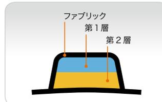
硬さの違う2素材のウレタンを使用し、第1層の低反発ウレタンで衝撃をしっかり吸収し、第2層の硬質ウレタンで長時間の使用でもつぶれること(型崩れ)がなく耐久性がUP。
