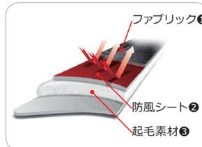
ストレッチ性に優れた軽量のUVケアファブリック①と保温性に優れた起毛素材③で、冷気を完全にカットする防風シート②を挟む3層構造で高いフィット性と防風保温が可能。
