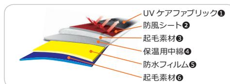
ストレッチ性に優れた軽量のUVケアファブリック①と保温性に優れた起毛素材③で冷気を完全にカットする防風シート②をサンドウィッチした特殊な素材をアウターに使い、保温用中綿④、防水フィルム⑤、起毛素材⑥によって、冷気のみならず、高次元での防水も可能とした。
